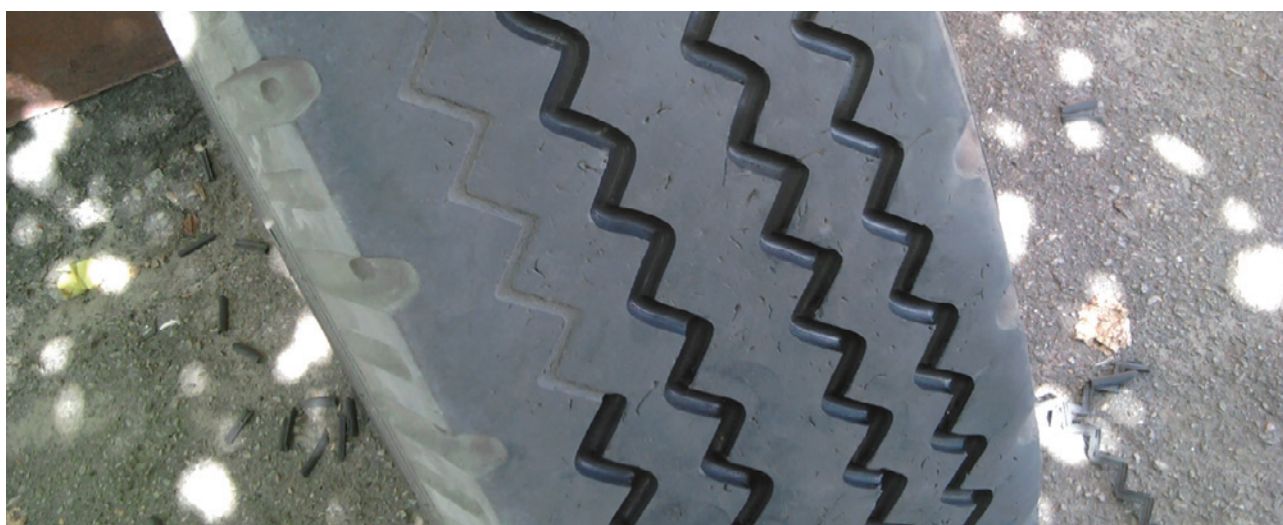
До и после нарезки протектора
